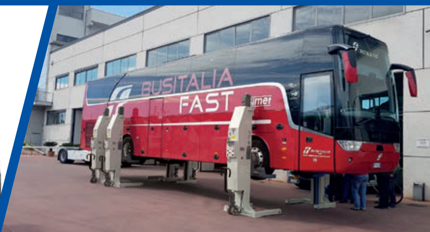
Sistema modulare con funzionamento a 4-6-8 colonne
