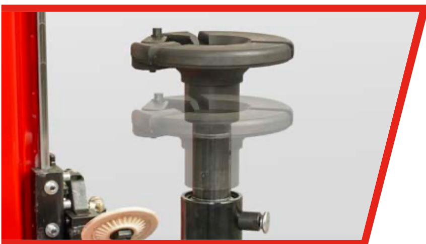
Platello centrale con altezza regolabile
