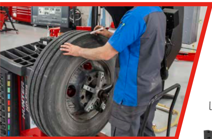
Montare cerchio e pneumatico in modo che i punti di Forcematching siano allineati per una guida fluida: prerogativa dell'equilibratrice HD Elite™
