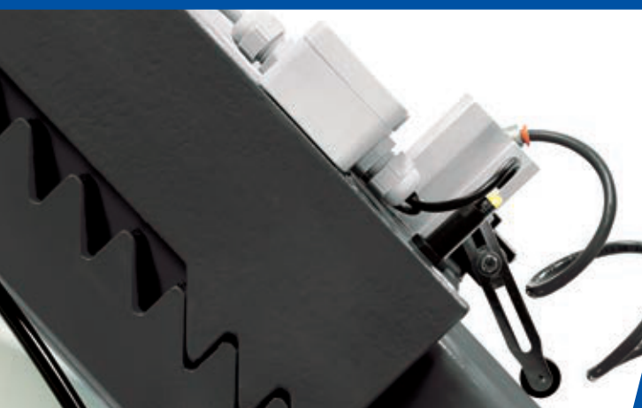
Sensore di prossimità per stazionamento millimetrico
