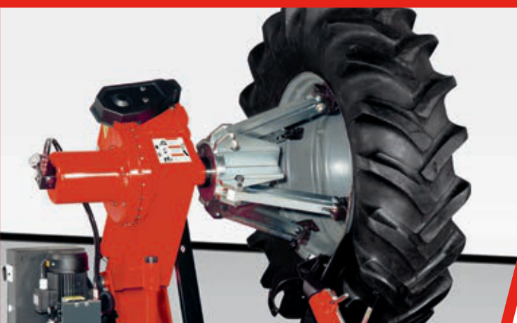
Il design dell'autocentrante a tulipano blocca e centra la ruota
