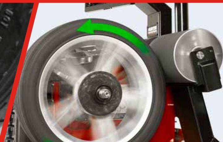
Risolvere i problemi di vibrazione migliorando il comfort di guida utilizzando il rullo di carico diagnostico
