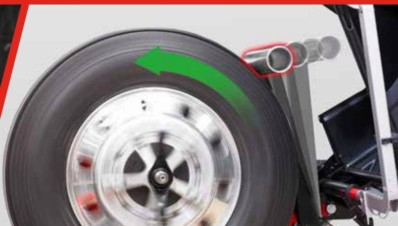
Risolve i problemi di vibrazione migliorando il comfort di guida utilizzando il rullo di carico diagnostico
