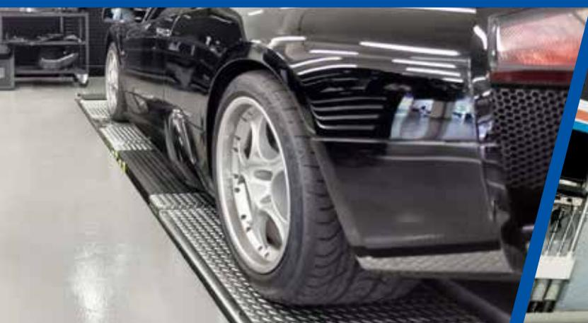
Piastre oscillanti posteriori bloccabili tramite comando pneumatico sulla centralina di comando. Incavo anteriore modulare per alloggiamento piatti
