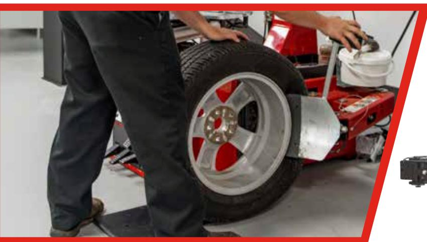
**Stallonatore laterale dotato di cilindro doppio effetto ad alta efficienza**
