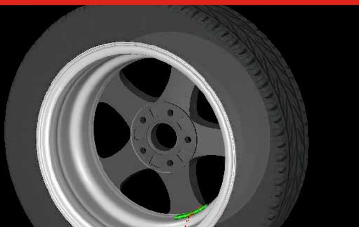
Applicazione del peso in qualsiasi posizione all'interno del canale ruota
