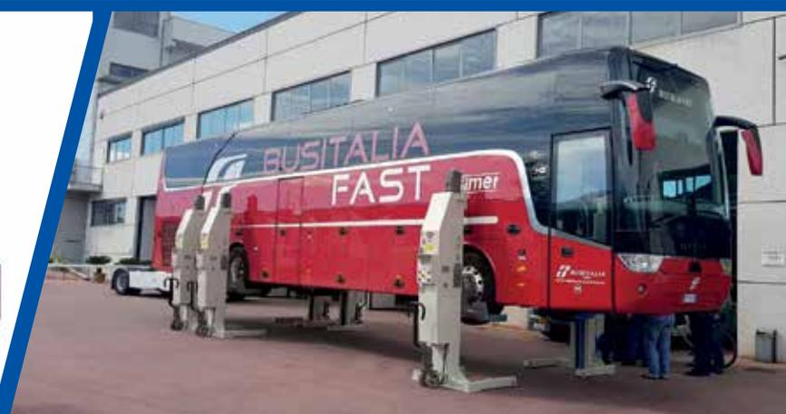
**Sistema modulare con funzionamento a 4-6-8 colonne**
